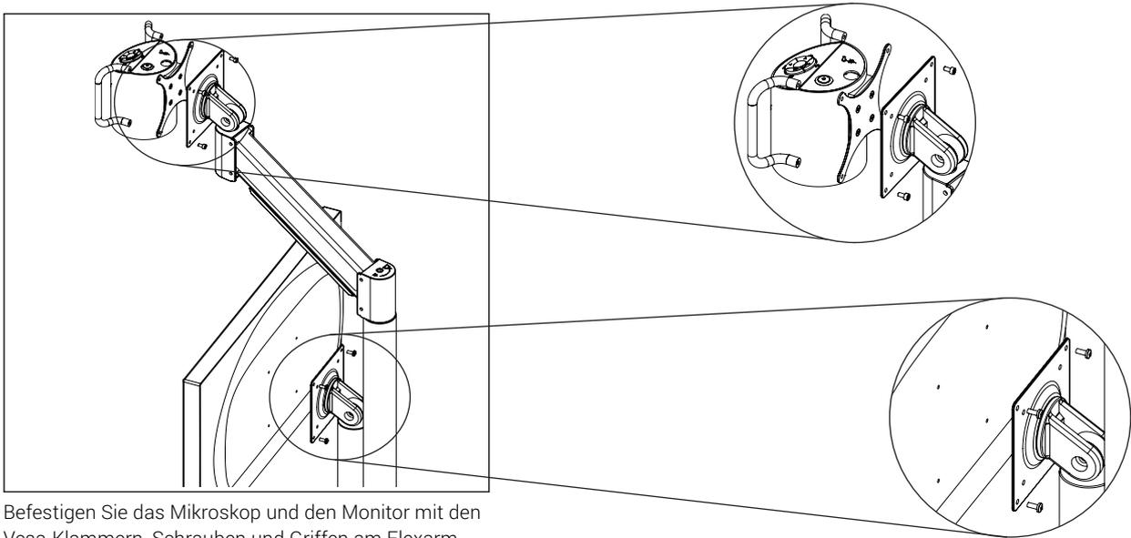
Befestigen Sie das Mikroskop und den Monitor mit den Vesa-Klammern, Schrauben und Griffen am Flexarm.
