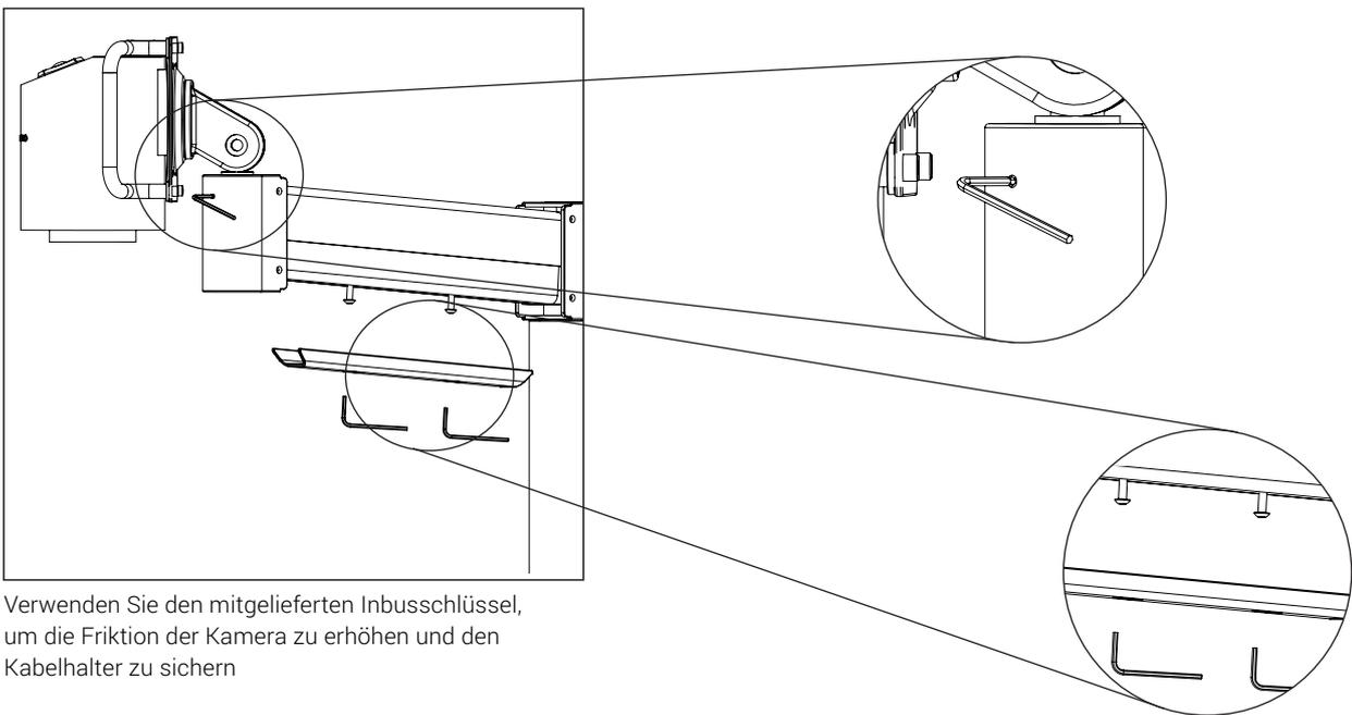
Verwenden Sie den mitgelieferten Inbusschlüssel, um die Friktion der Kamera zu erhöhen und den Kabelhalter zu sichern
