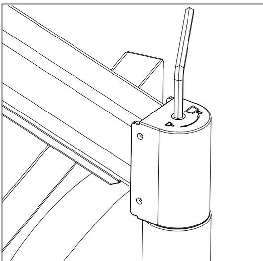
Stellen Sie den Flexarm ein, indem Sie ihn mit dem mitgelieferten Inbusschlüssel im Uhrzeigersinn festschrauben.
