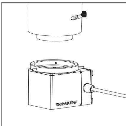
Die Coaxial light am das Mikroskop befestigen
