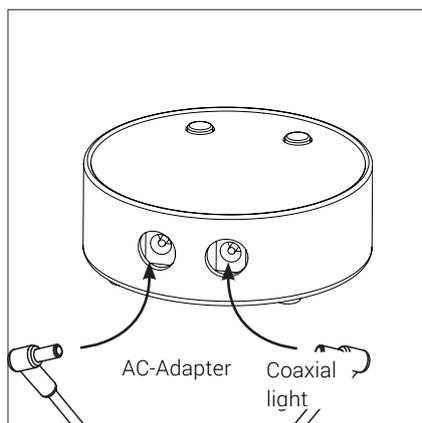
Coaxial light und AC-Adapter an die Bedienungsbox anschließen
