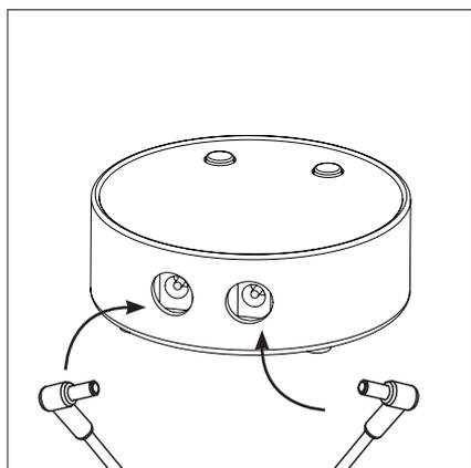
Verbinden Sie die Hintergrundbeleuchtung und das Netzteil mit der Bedienungsbox. Bitte vor dem Gebrauch korrekt verbinden.
